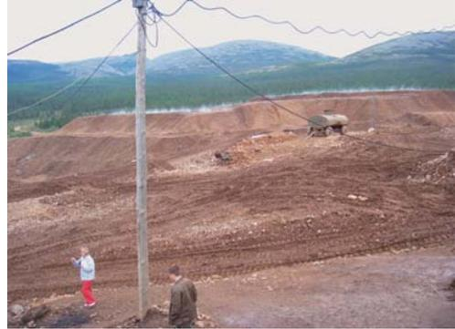
写真9 セリグダール社の露天掘り金鉱，遠方の白い飛沫は青酸ソーダのスプレー
