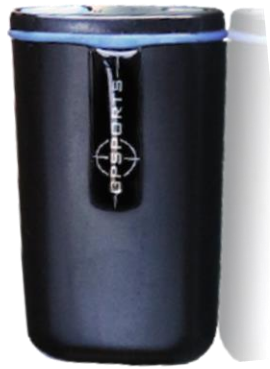
図 2-1. GPS ユニット (SPI Pro X II; GPSports Systems) サイズ: 74mm×42mm×16mm 重量: 67g
