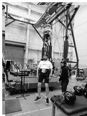
写真5 身体懸垂式体重免荷装置とトレッドミル
