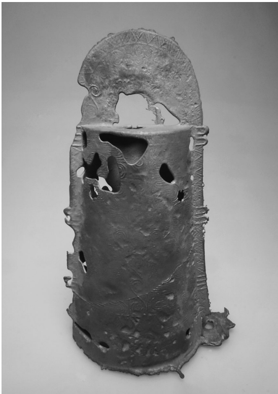
図 29 1回目の鋳造で製作した銅鐸（左：A面 右：B面）
