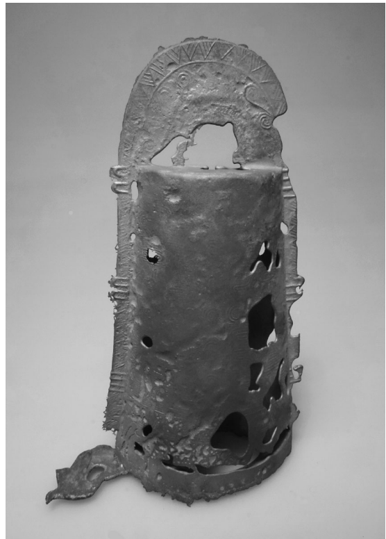
図 29 1回目の鋳造で製作した銅鐸（左：A面 右：B面）
