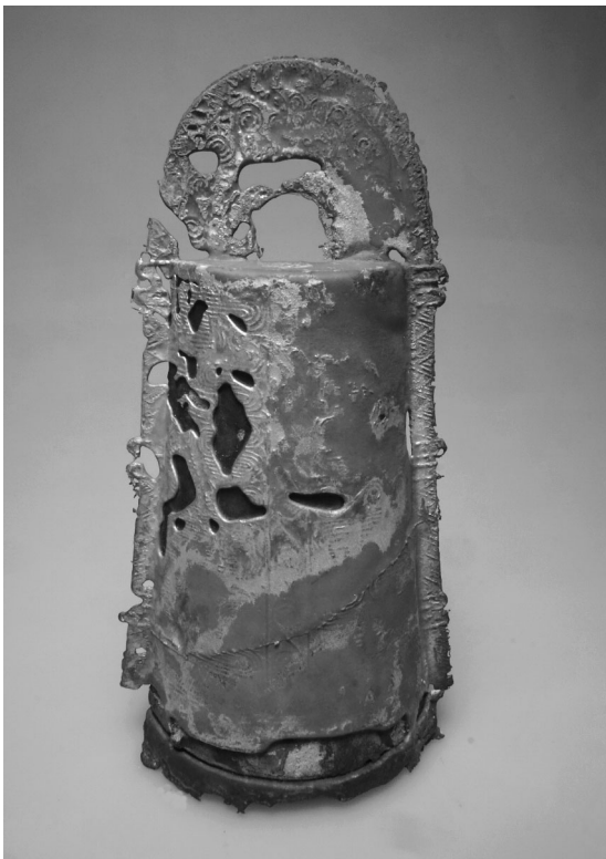
図 30 2回目の鋳造で製作した銅鐸（左：A面 右：B面）
