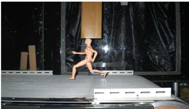
図3.1 風洞用ムービングベルト及び走行模型（写真）
