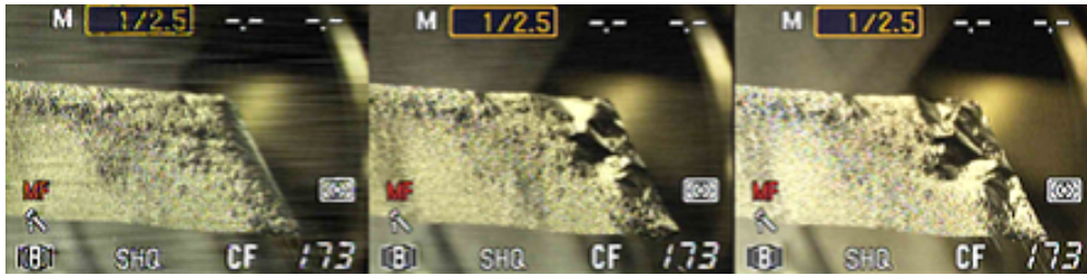
図 5.1 ビーム照射によって劣化していくフォイルの様子 [2].
