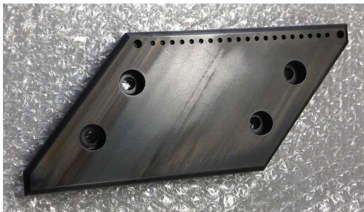
図 1.8 LHD 実験後の損傷後した炭素材ダイバータ [1].
