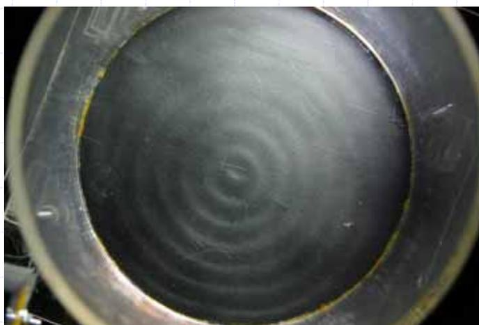
振動数18(Hz), 振幅0.3(mm)
