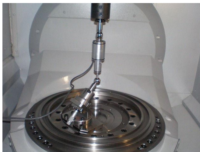
図 2.20 旋回軸のアキシャルモーションを測定するためのセットアップ
